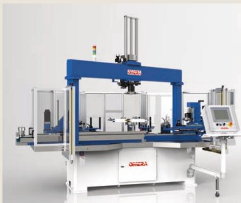
pezzi. Durante le fasi di fermo e cambio coil sullo svolgitore c'è la possibilità di alimentare i quadrotti in tempo mascherato tramite un secondo sistema che consente di non interrompere l'operatività della linea.
